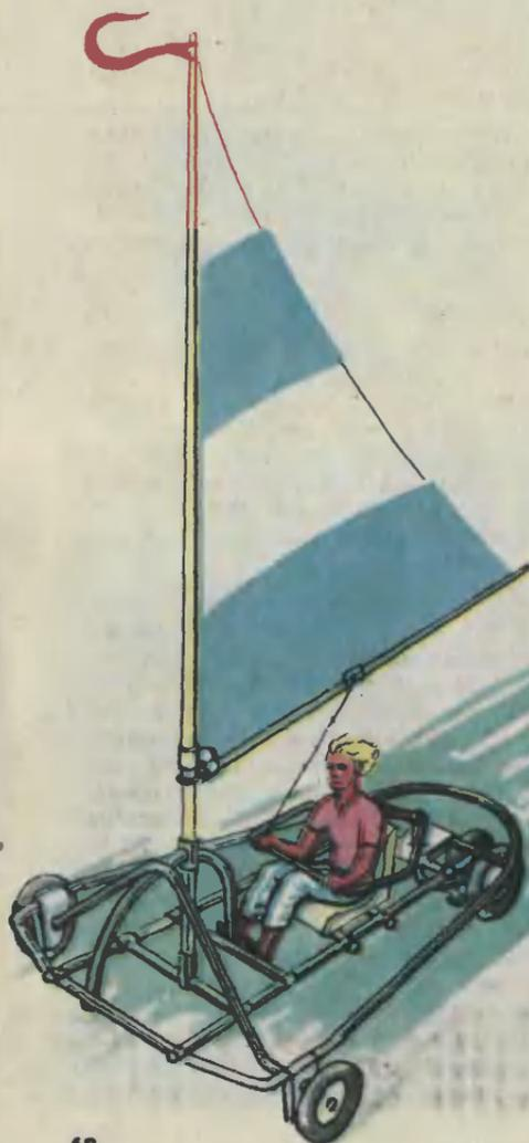
Следовательно, у буера три точки опоры с расстоянием между осями 1300 мм и базой 1650 мм. Нетрудно заметить, что основную нагрузку воспринимает внешний обод рамы. Его придется изготовить из водопроводной трубы дюймового диаметра. Концы труб соединены внутренней переходной втулкой и заклепаны.
